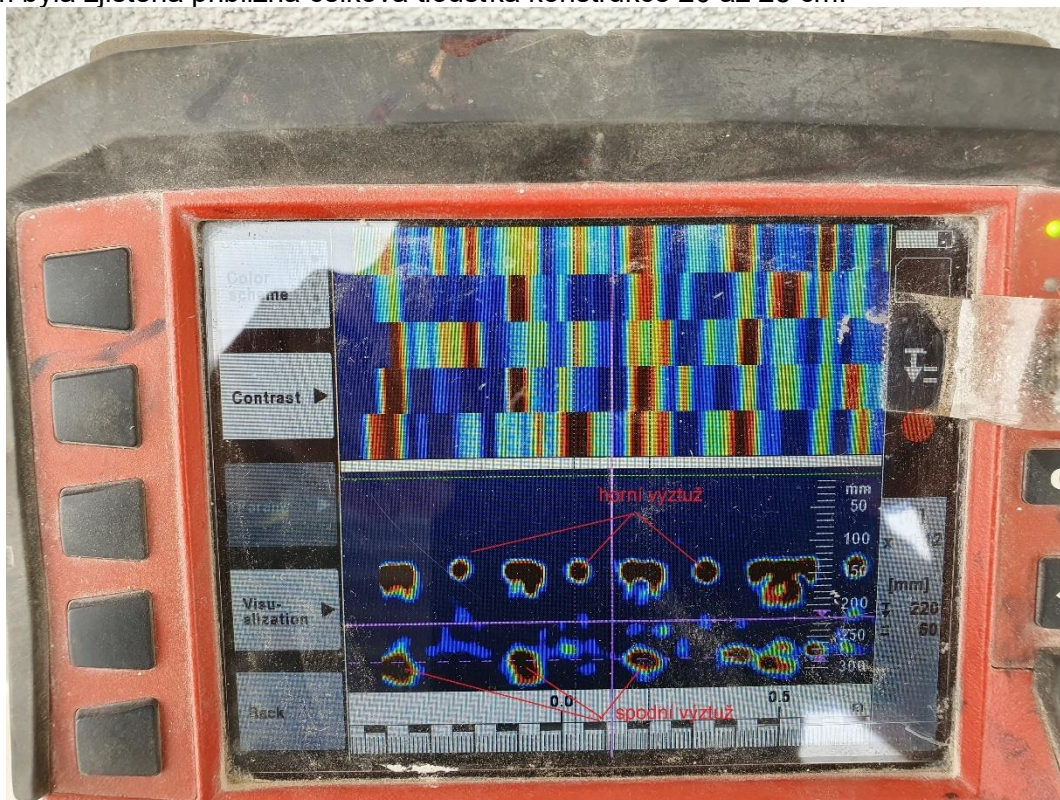
Obr. 15 - Měření profometrem s vyznačením výztuže
